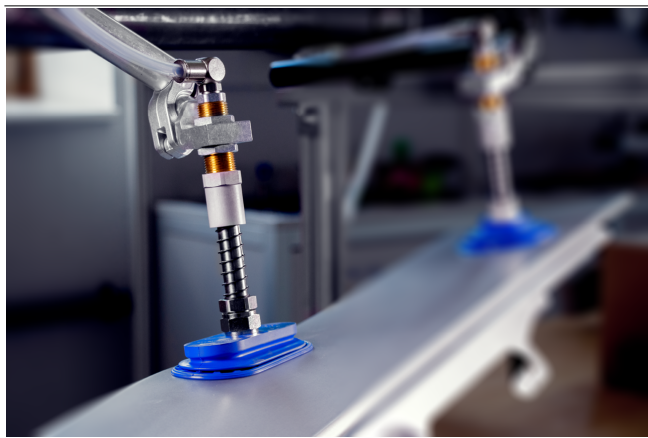
Supporti per aste a molla HT-FST in combinazione con aste a molla FSTE-HDB per la movimentazione di una lamiera
